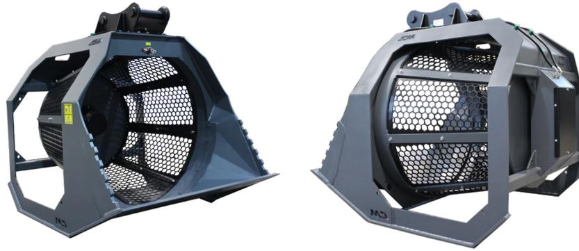
Siebschaufel mit einem Korb aus verbolzten Austauschgittern. Ausgelegt ist die Schaufel für das Sortieren von Materialien wie etwa Flussbetten, steinigem Erdreich oder aus Abbrucharbeiten stammenden Inertstoffen.
