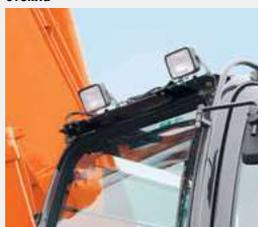
Дополнительные передние фонари освещения на крыше кабины
