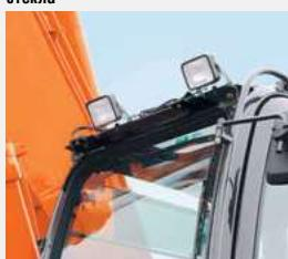
Дополнительные передние фонари освещения на крыше кабины
